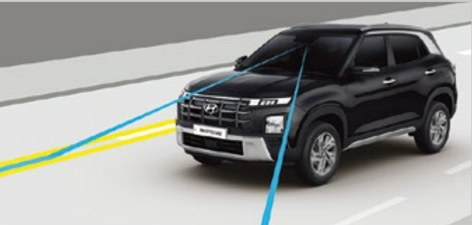
Hỗ trợ giữ và duy trì làn đường LFA-LKA
